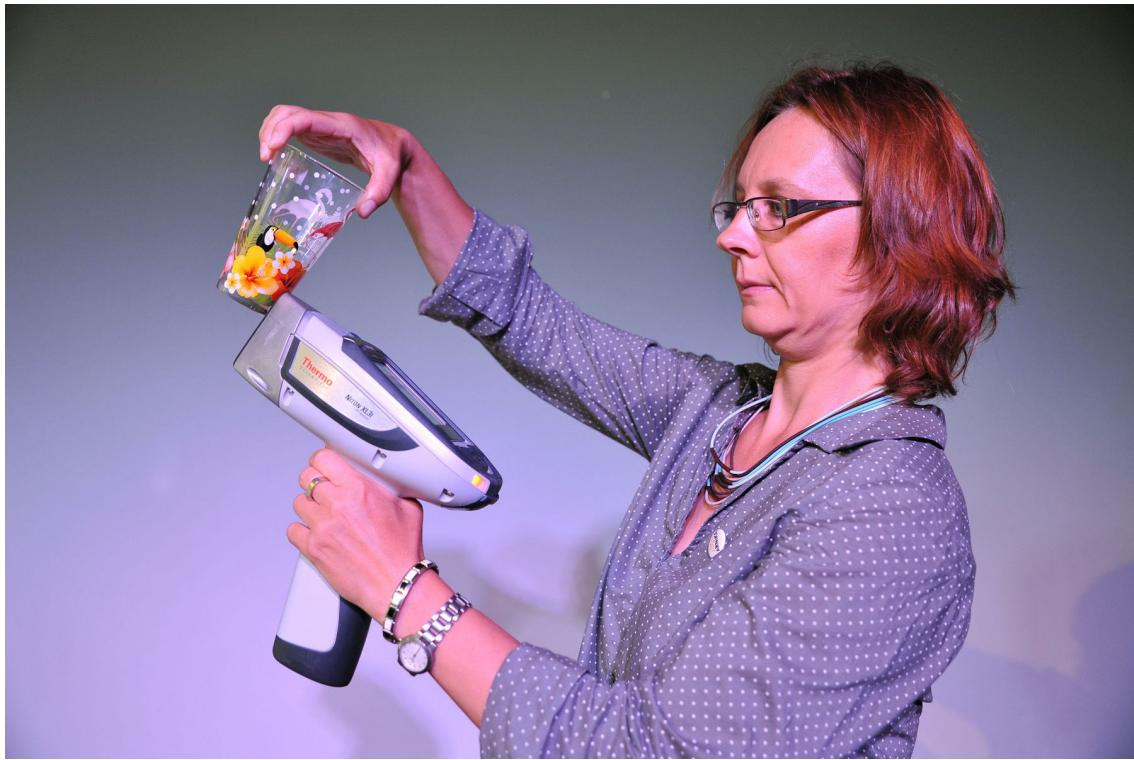
كارولينا برابوفا وهي تستخدم جهاز XRF لقياس المواد الكيميائية الخطرة في المنتجات. حقوق الصورة: مارتن سفروزيليك
