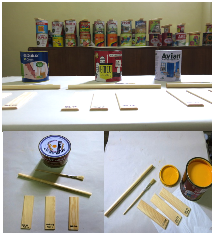
Gambar 7. Penyiapan pengambilan conto cat.
