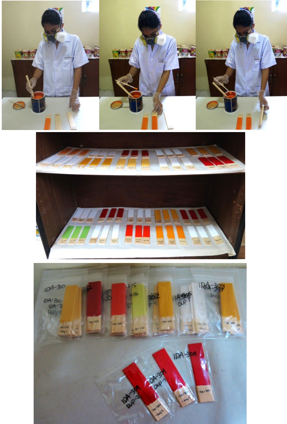
Gambar 8a. Pengadukan cat dan pengulasan cat pada kayu (atas).
