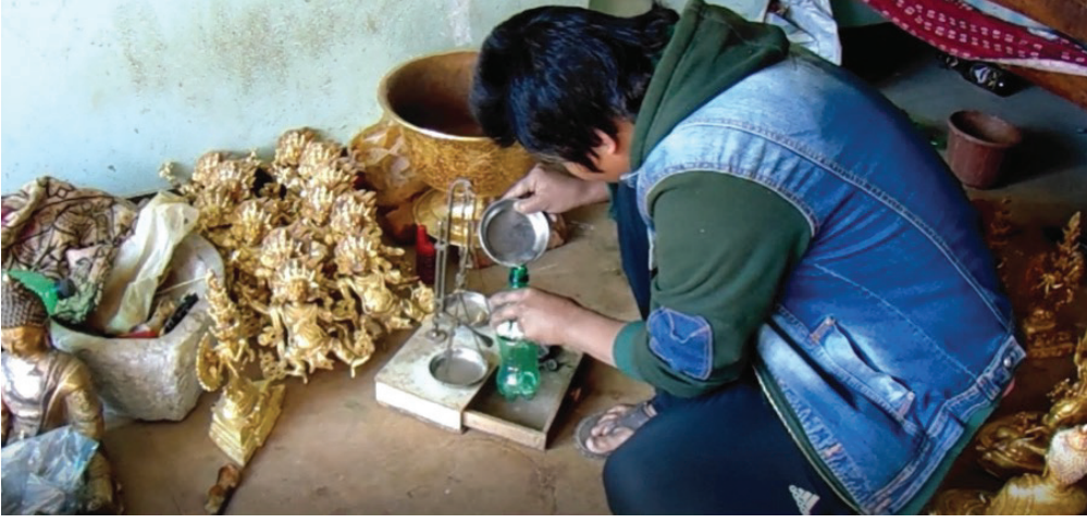
الشكل رقم 1. عمال الطلاء في النيبال يضعون عينة الزئبق/الذهب على التماثيل ويحرقونها بواسطة مشعل. (المصدر: CEPHED). (المصدر: CEPHED)
