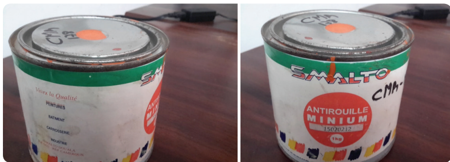
Figure 4. Une peinture anticorrosive étiquetée comme antirouille «minium» contenant 220 000 ppm de plomb est qui est présentée comme «peinture de qualité», destiné à être utilisés pour diverses applications, y compris au sein de l'environnement familial.»
