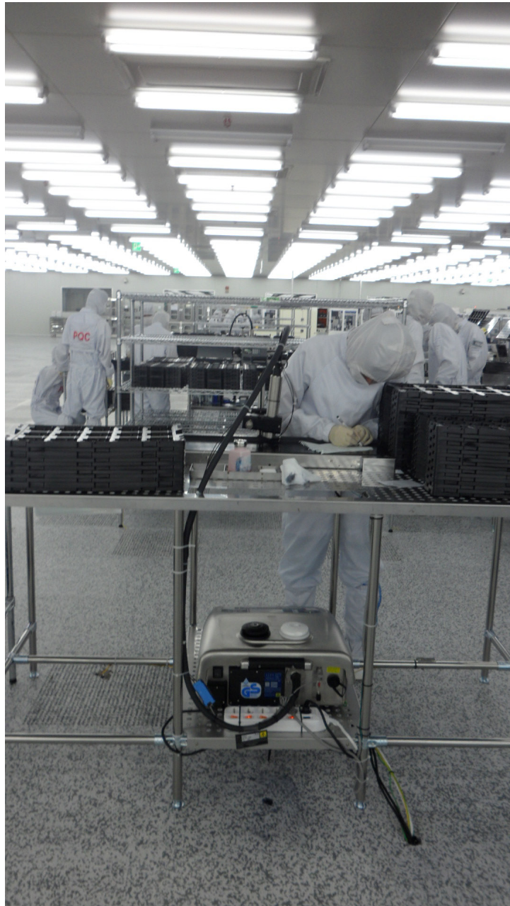
삼성 박닌 휴대폰 공장의 마킹 설비. 국소 배기 장치가 설치되어 있지 않아 독성 화학물질이 방출되고 있다.
