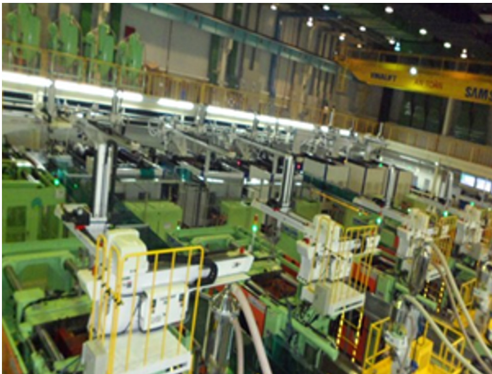
삼성 박닌 휴대폰 공장의 사출 성형 공정. 국소 배기 장치가 설치되어 있지 않아 독성 화학물질이 방출되고 있다.
