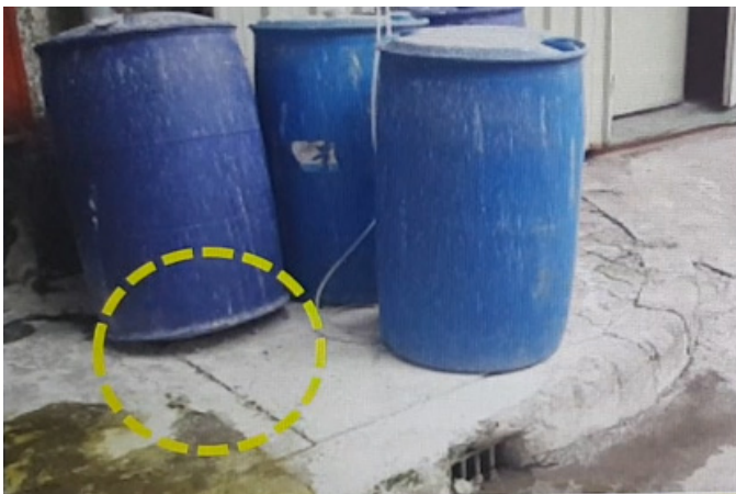
삼성전자 협력업체들에서 용기에서 유출된 화학물질이 방치되고 있는 모습. 지정폐기물 보관소에 확산 방지 시설과 지붕을 갖추지 않아 폐화학물질이 인근 우수관으로 배출되고 있다.
